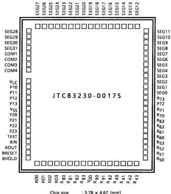
Chip size : 3.78  $\times$  4.67 (mm) Chip thickness : 450  $\pm$  30 ( $\mu$ m) : V<sub>SS</sub> : 100 (μm<sup>□</sup>) Substrate Pad size
